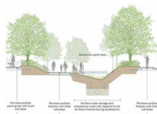
SuDS Sezione percorso ciclopedonale - canale - strada
