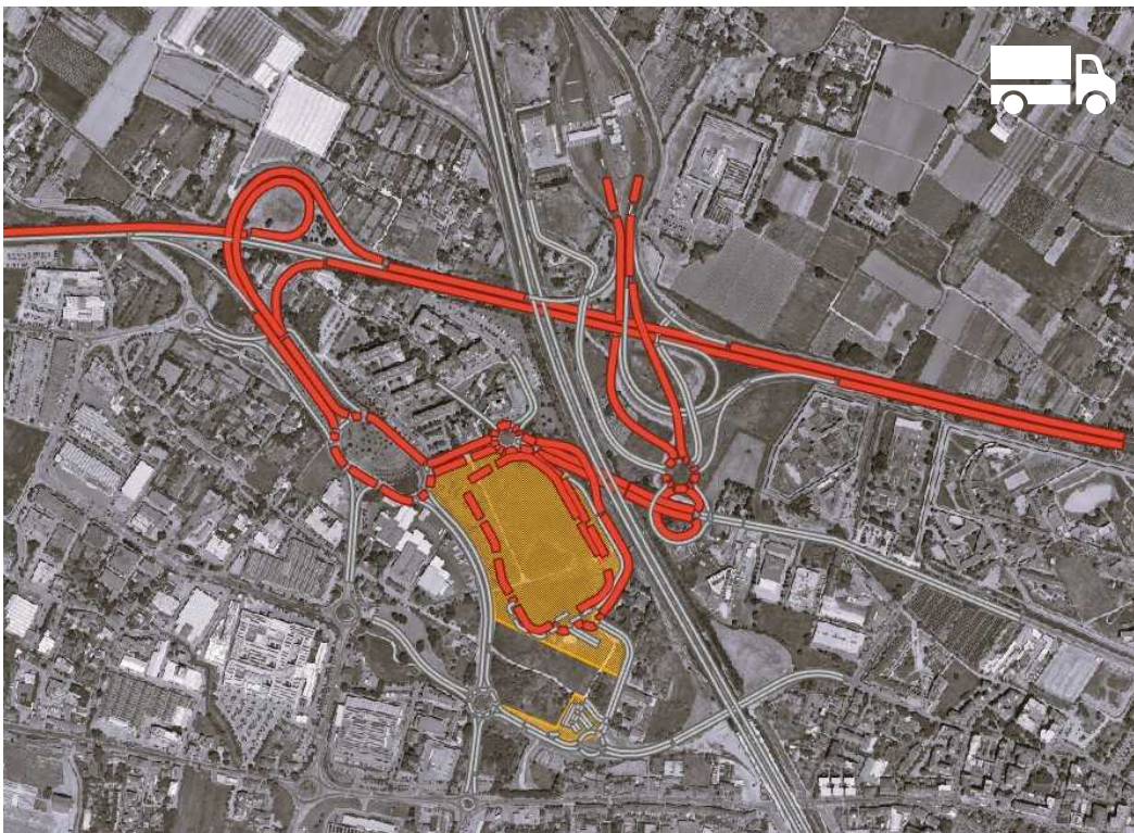
Figura 10 – Scenario di Progetto – Percorsi veicoli Commerciali pesanti attività logistica – INGRESSO e USCITA
