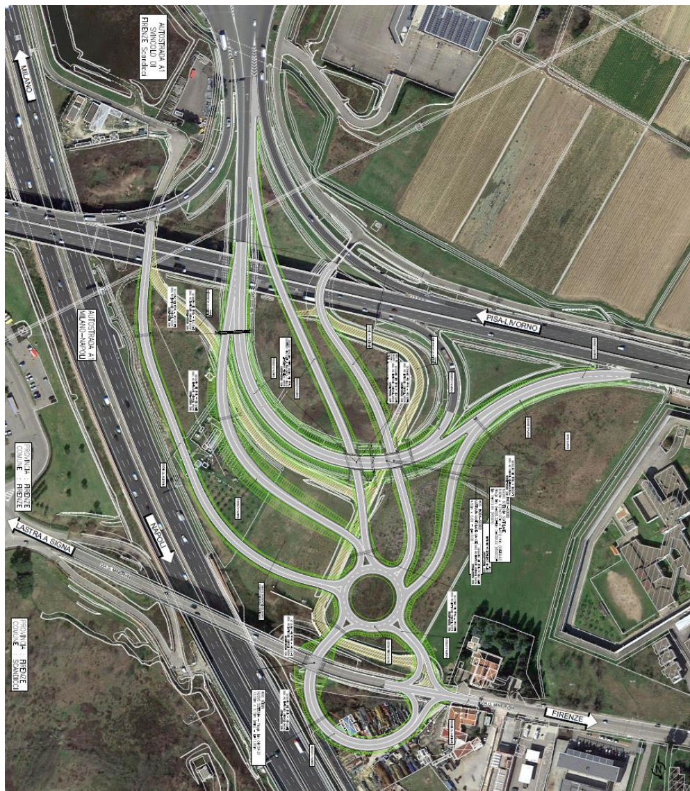
Figura 26 – Inserimento su ortofoto – progetto nuovo svincolo Scandicci [fonte: Autostrade per L'Italia]
