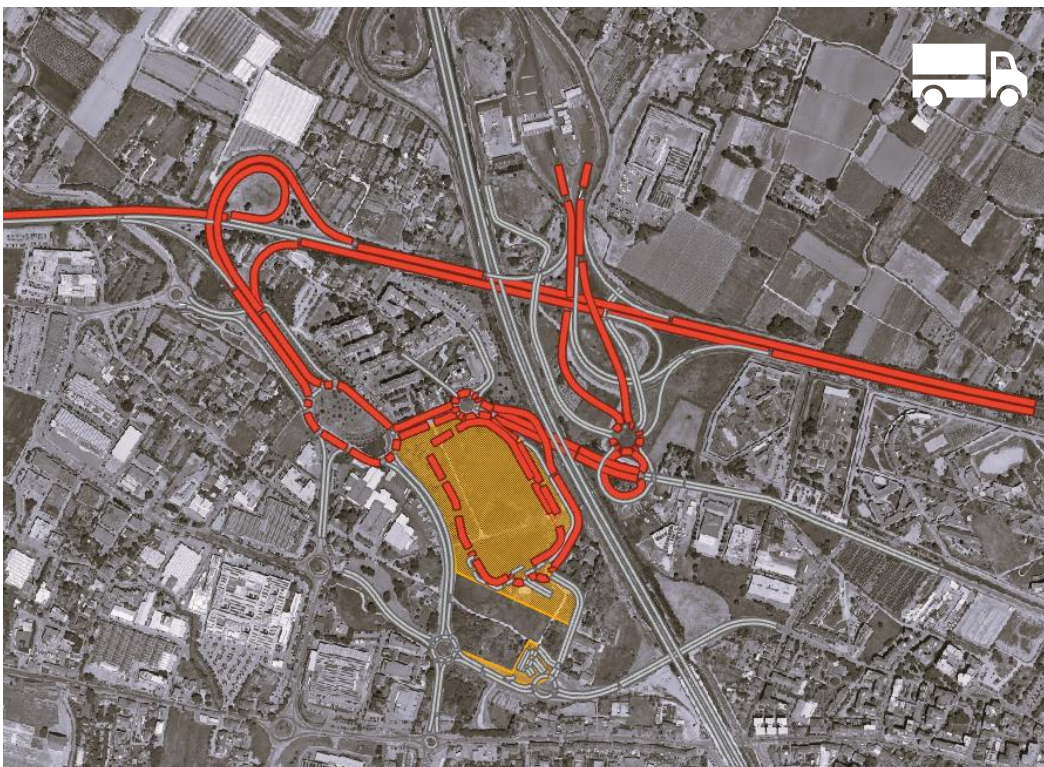
Figura 33 – Scenario di Progetto – Percorsi veicoli Commerciali pesanti attività logistica – INGRESSO e USCITA
