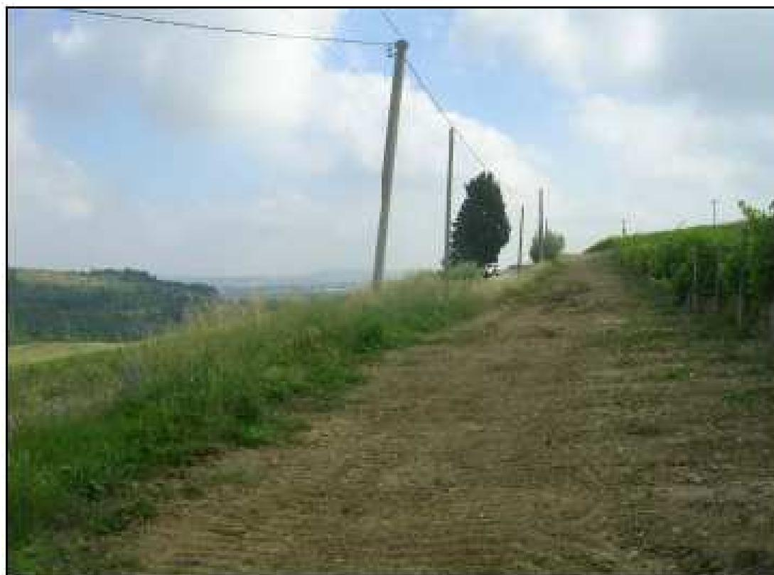
**Figura 451: la zona a monte della strada comunale. Si possono notare i pali della linea elettrica ruotati verso monte.**
