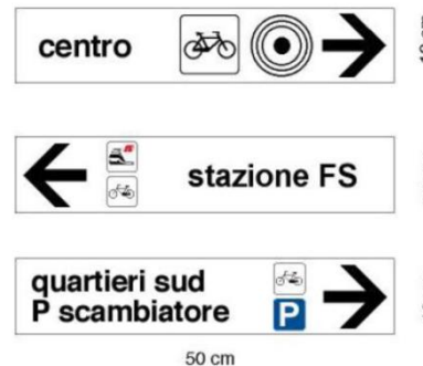
Fig 2: Segnali di direzione urbano (sottodimensionati per viabilità riservata) composto da fig. tab Il 13/a e figure art. 125 DPR 495/92)
