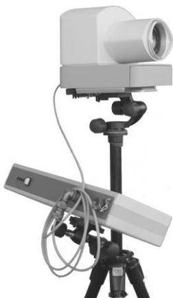
Nella figura qui a fianco è riportata un esempio di installazione con CPU106 e barra laser 106 standard su cavalletto.
