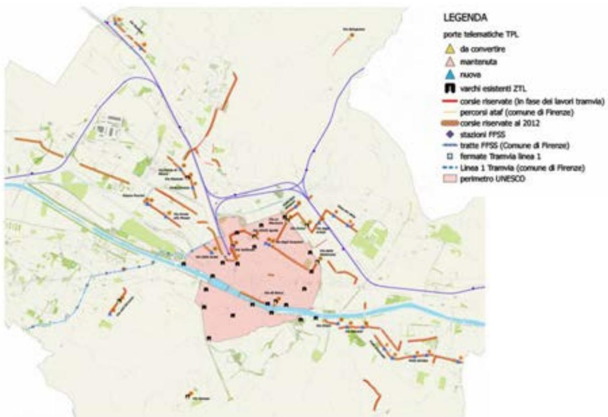
Estensione del sistema di protezione con varchi telematici delle corsie riservate al TPL
