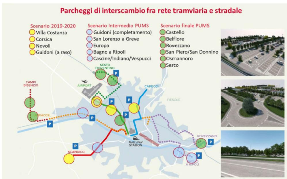
La realizzazione del **sistema tramviario** può garantire i livelli di regolarità, capacità ed accessibilità che sono richiesti al sistema di trasporto pubblico per la città di Firenze nel futuro. La portata del progetto tramviario può essere ulteriormente ampliata agendo su due importanti fattori infrastrutturali:
