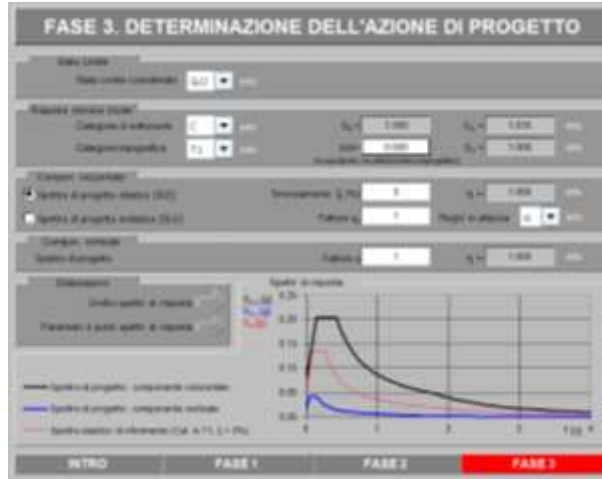
Parametri e punti dello spettro di risposta orizzontale per lo stato limite: SLO
