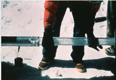
>Vengono prelevati con particolari trivelle dei cilindri di ghiaccio.
