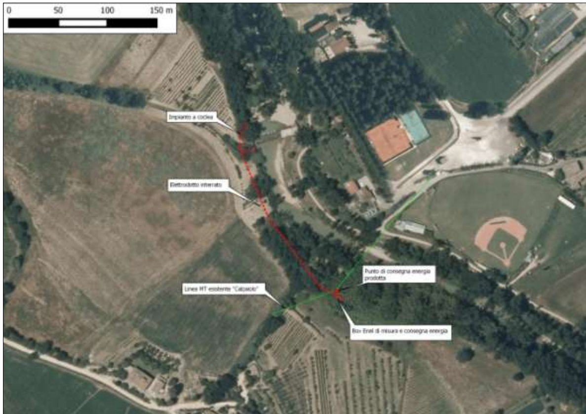
Figura 3-5: Planimetria delle opere di connessione alla rete elettrica in progetto.
