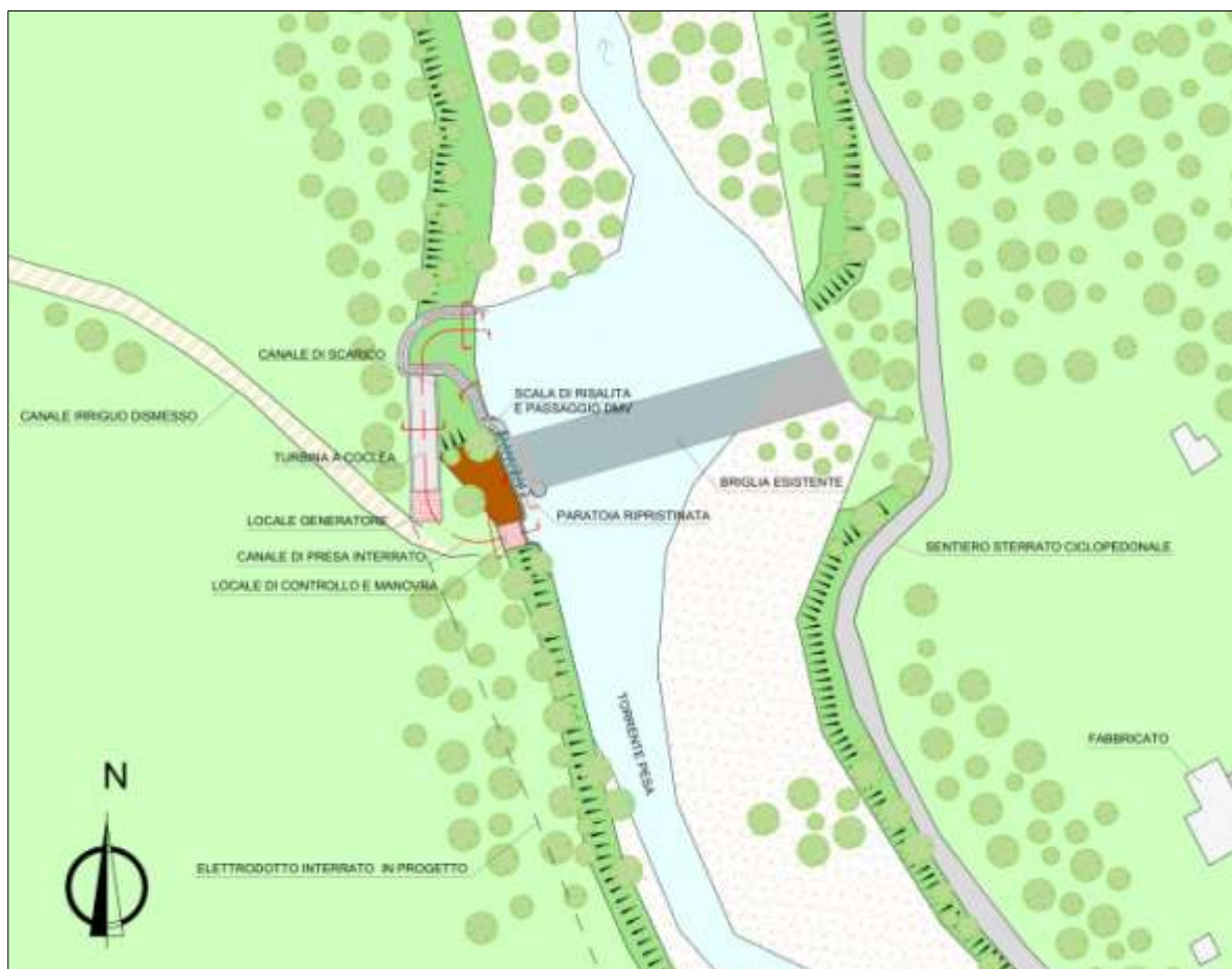
Figura 12: planimetria dell'area dove si prevede di posizionare l'impianto idroelettrico.
