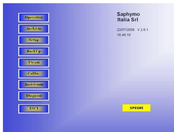
Fig 6 i pulsanti per la configurazione e manutenzione sono sbloccati.
