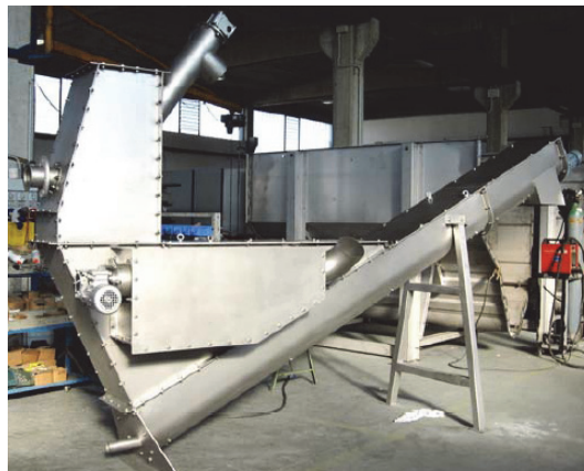
Comparto fuori terra di grigliatura, dissabbiatura, disoleatura Mod. Minytop 3 ditta Maind
