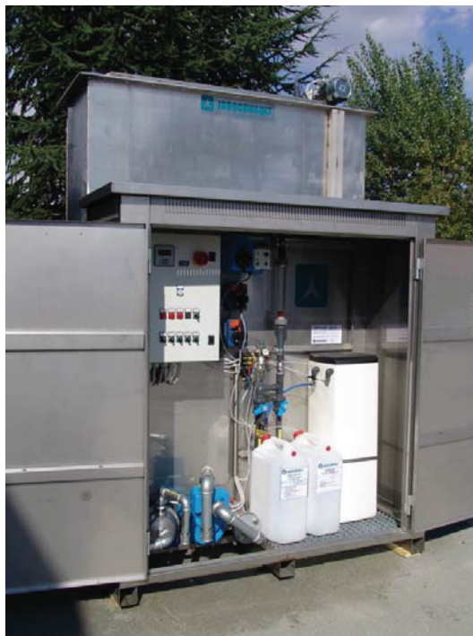
Comparto fuori terra di chiariflocculazione Mod. SL1 ditta Idroconsult Srl
